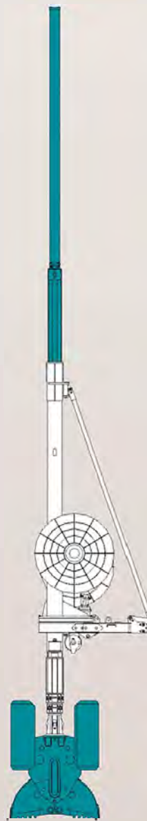
KRC - DRAPÁK PRO VÝROBU PODZEMNÍCH STĚN Depth/Hloubka 37 m Trench/Výkop 1200 x 3000 mm
