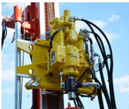
Testa roto-percussione Hydraulic drifter Tête roto percusion Hydraulikhammer Cabeza con martillo hidráulico Гидромолот
